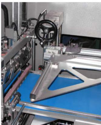
Dazu müssen einerseits die Stapel von den beiden Auslaufschienen der Produktionsanlage auf ein (optional erhältliches) Förderband geschoben werden, welches als Zulauf zur Verpackungsanlage dient und dann die Maskenstapel in der Verpackungsmaschine verpackt, verschlossen und ggf. evakuiert sowie gelabelt werden. Hierzu bieten sich automatische Verpackungsautomaten an, aus denen dann fertig eingetütete Maskenstapel
