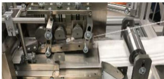
Zur Herstellung von Mund-Nasen-Schutz Masken ähnlich DIN EN ISO 14863 wird eine dreilagige Gewebestruktur aufgebaut und verschweißt, oft bestehend aus Polypropylen-Spunbond und -Meltblown.
